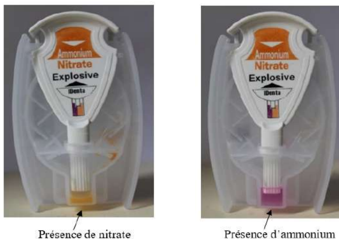
Figure 2 : Révélation de la présence de nitrate d'ammonium avec le Kit IDenta
